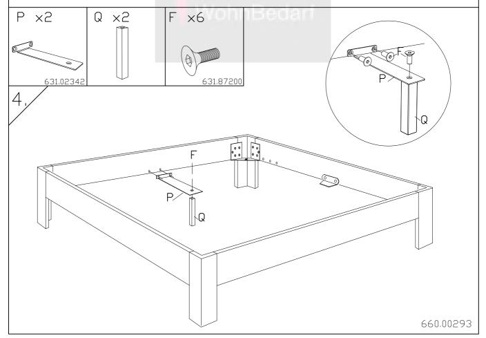
zusätzlich bei Fusshöhen 25 und 30cm additional for feed height 25 and 30cm en plus pour les hauteur de pieds 25 et 30cm supporti addizionali per piedi di 25 e 30cm
